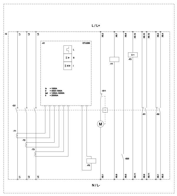
L (Long Time Delay / Überlastochutz); S (Short Time Delay / Kurzschlussschutz, kurzzeitverzögert); I (Instantaneous / Kurzschlussschutz, unverzögert);
